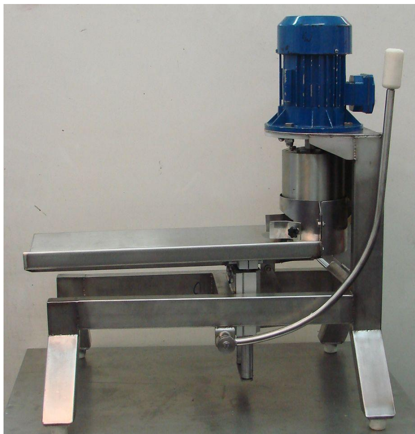
Rys 3. Dziesiąty prototyp urządzenia do odgławiania ściem okołoskrzelowym po łuku
