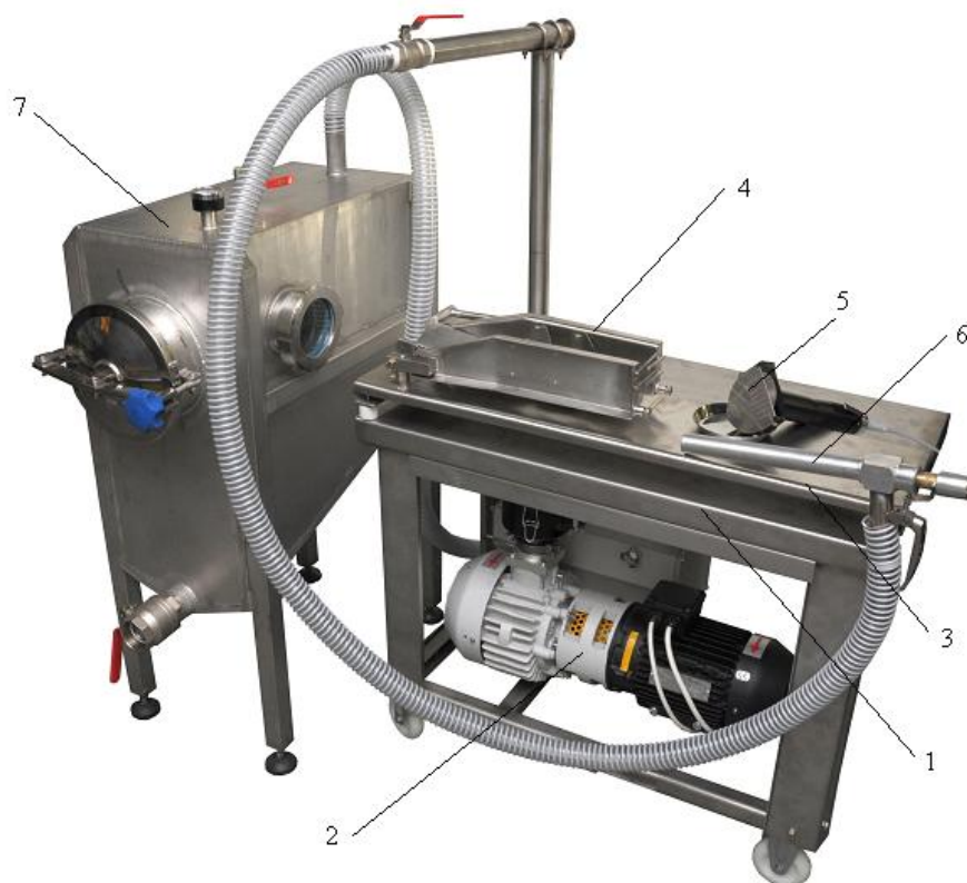
Rys. 4. Prototyp urządzenia do patroszenia karpia: 1 - stół obróbczy, 2 - pompa próżniowa AT-63B, 3 - podstawa niecki mocująco-centrującej rybę, 4 - niecka mocująco-centrująca rybę, 5 - nóż elektryczny POTIS S150 PLUS, 6 – ssawka ręczna, 7 – zbiornik na odpady.
